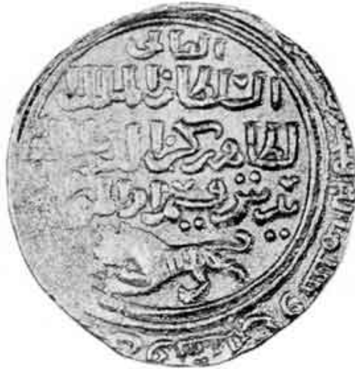
Monnaie de Beibars présentant un blanc étendu (à gauche) résultant d'un manque partiel d'épaisseur qui provient de la production du flan par coulée.
